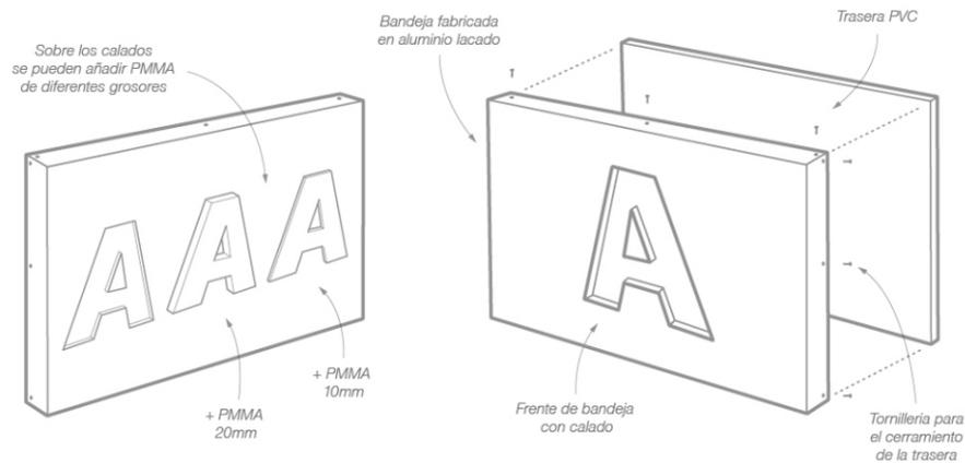
A la bandeja calada se le realiza en el frente un vaciado para que así se pueda iluminar mediante leds en su interior. La marca iría en relieve las zonas con mayor volumen con metacrilato blanco opal de 10mm y sin volumen las partes con menor tamaño. La bandeja estaría cerrada mediante contrabandeja oculta de aluminio.
